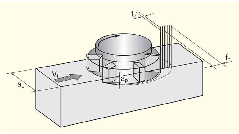
$V_c$  : 切削速度 (m/min)       $Z$  : 刃数
